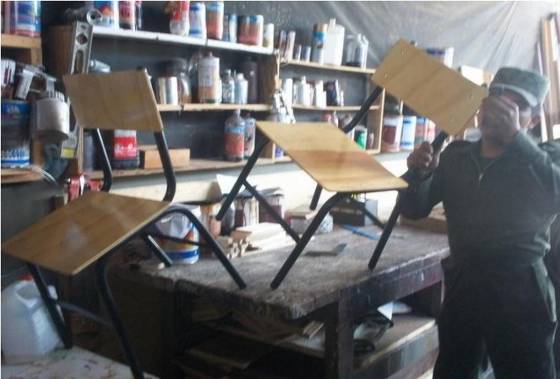
El personal del taller de tapicería, realiza trabajos de mantenimiento y reparación de sillas tipo secretarial y sillas de madera de diferentes modelos.
