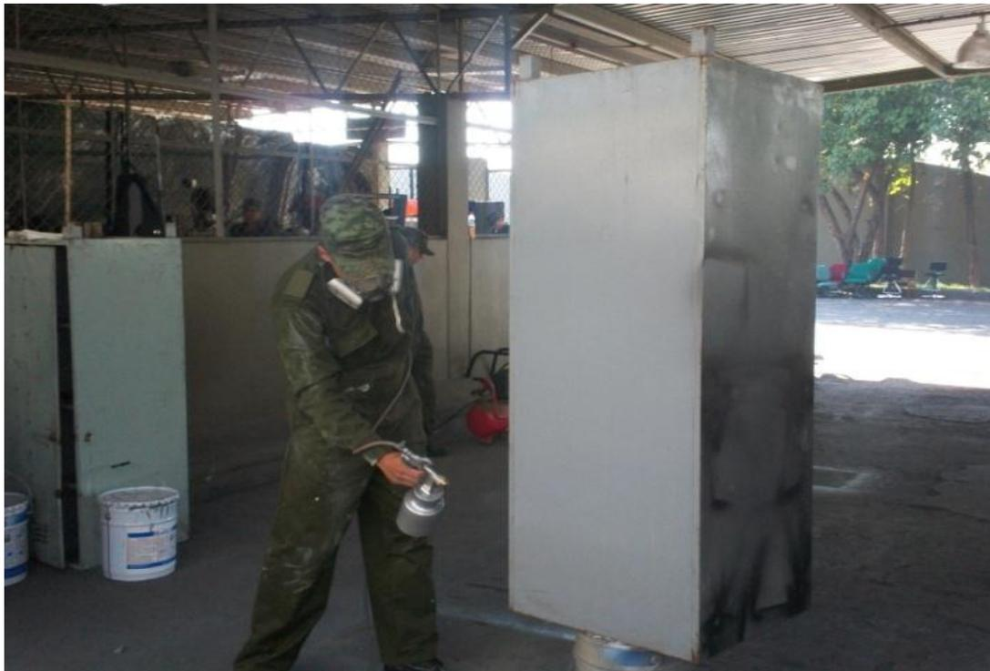
El taller de pintura, realiza trabajos de mantenimiento y reparación, a gabinetes tipo universal y de literas metálicas.
